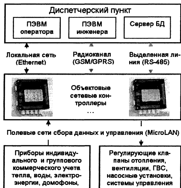
Рис. 1. Структура АСДУ теплоснабжением зданий
