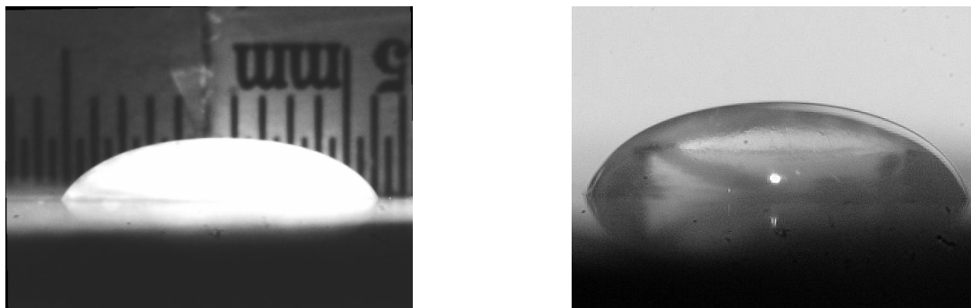
Рис. 6. Боковые профили лежащих капель воды (слева) и глицерина (справа)
