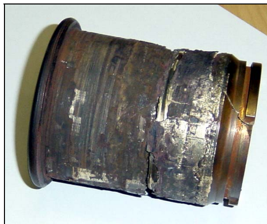
Рис. 8. Втулка пускового подшипника после разрушения. Вид 1
