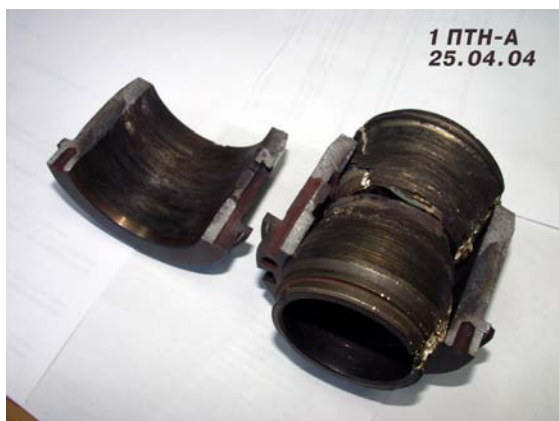
Рис. 2. Разрушенный вкладыш пускового подшипника
