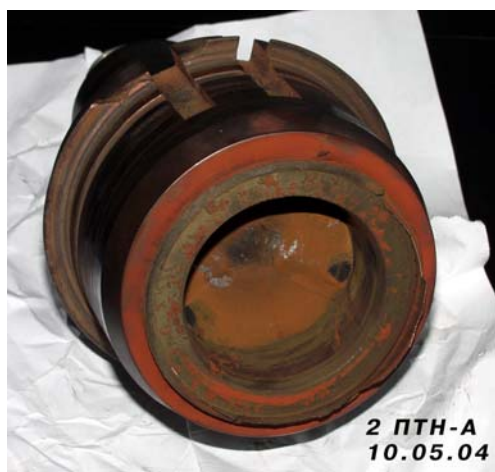
Рис. 4. Поверхность долома вала питательного насоса
