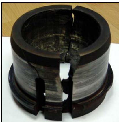
Рис. 5. Корпус пускового подшипника после разрушения. Вид 1
