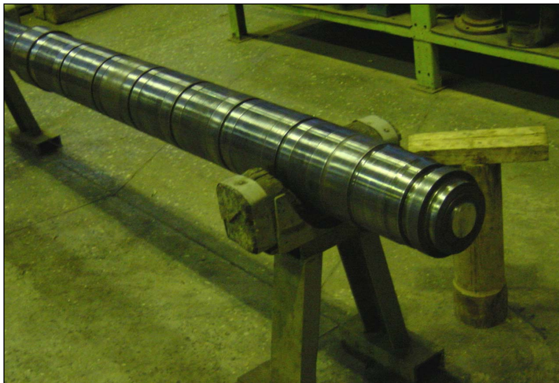
Рис. 13. Корпус уплотнения и вал с усталостной трещиной. Вид 2
