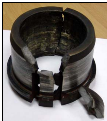
Рис. 6. Корпус пускового подшипника после разрушения. Вид 2
