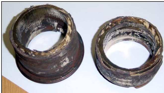
Рис. 10. Втулка пускового подшипника после разрушения. Вид 3
