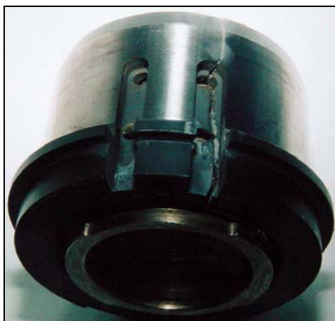
Рис. 3. Фрезерованные пазы для гидростатического подвода конденсата
