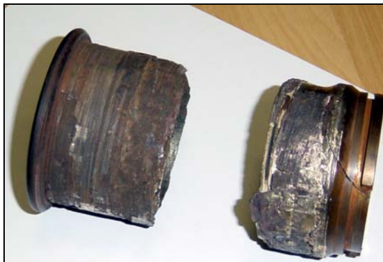
Рис. 9. Втулка пускового подшипника после разрушения. Вид 2
