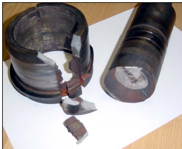
Рис. 11. Корпус уплотнения и вал с усталостной трещиной. Вид 1
