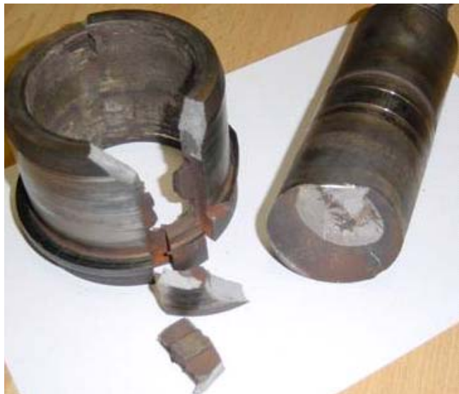
Рис. 1. Корпус подшипника и вал с усталостной трещиной (НВ ГРЭС)
