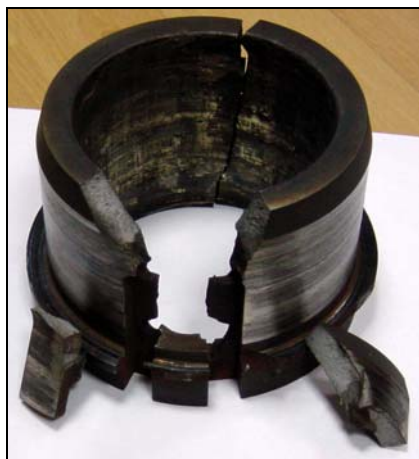
Рис. 7. Корпус пускового подшипника после разрушения. Вид 3
