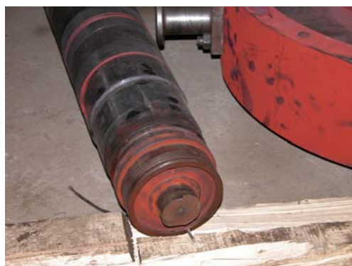
Рис. 6. Поверхность долома вала питательного насоса
