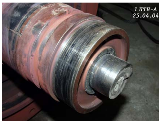
Рис. 3. Разрушенный участок вала
