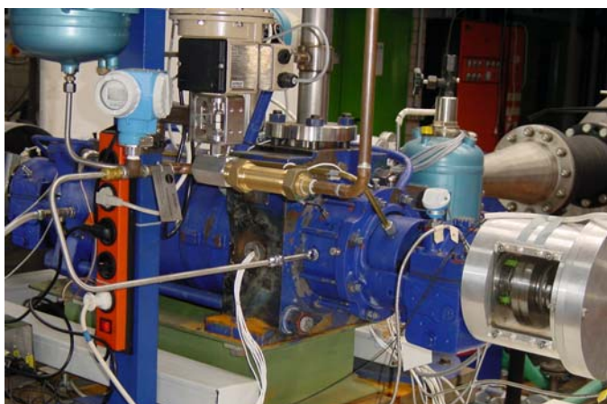
Рис. 6. Взаимовлияние осевых сил и измерение осевых сил на многоступенчатом насосе высокого давления с разгрузочным поршнем
