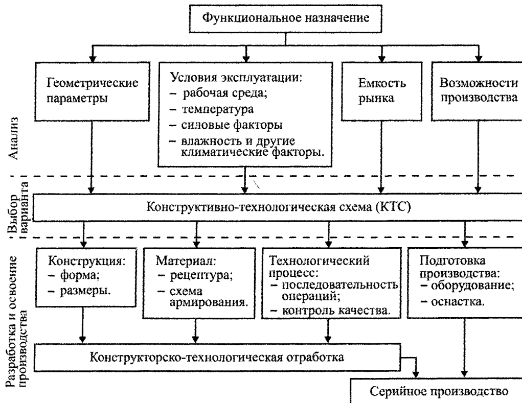
Рис. 3. Последовательность действий в процессе создания конструкции из ПКМ
