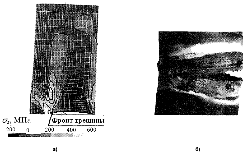
Рис. 7. Окружная трещина в цилиндрическом образце: а – КЭ расчет (осевые напряжения); б – результат эксперимента
