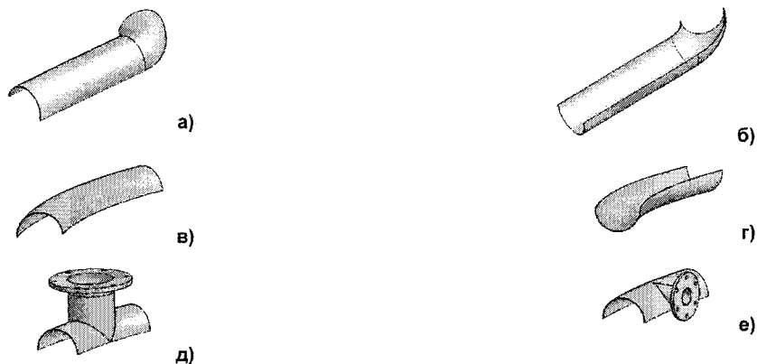
Рис. 6. «Скорлупки»: а – верхняя «скорлупка» сектора 1Б; б – нижняя «скорлупка» сектора 1Б; в – верхние «скорлупки» секторов 2Б...8Б, 10Б...13Б; г – нижние «скорлупки» секторов 3Б, 4Б, 6Б, 7Б, 9Б, 10Б, 11Б, 13Б; д – верхняя «скорлупка» сектора 9Б; е – нижние «скорлупки» секторов 2Б, 5Б, 8Б, 12Б
