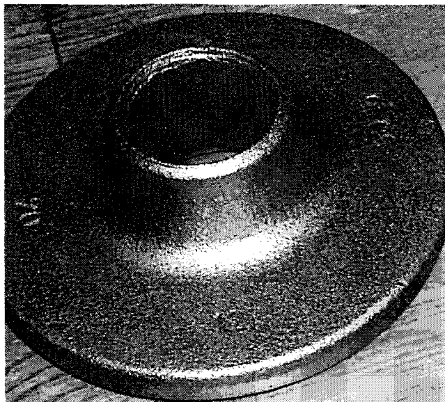
Рис. 8. Поковка фланца Р у 16 D у 50, изготовленная по открытой схеме ПРВК
