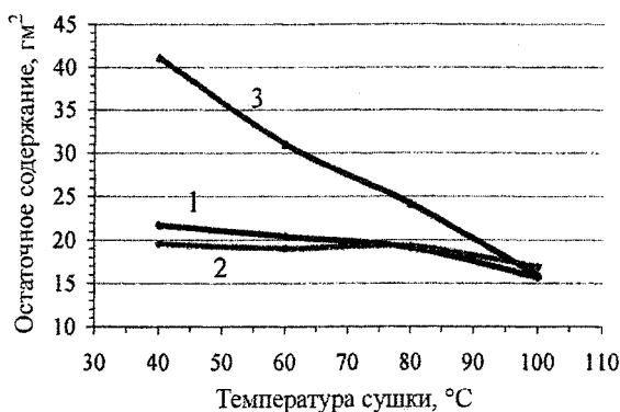
Рис. 2. Зависимость остаточного содержания ингибиторов Koring в бумаге от температуры сушки: 1 – бумага с ингибитором Koring 505; 2 – бумага с ингибитором Koring 501; 3 – бумага с ингибитором Koring 141
