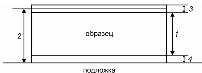
Рис. 5. 1 – Реальная толщина образца, 2 – толщина, рассчитанная по МСЭ, 3 – внешний оксидный слой, 4 – переходный слой
